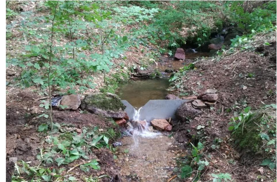
Wehr + Drucksensor (Abfluss)
