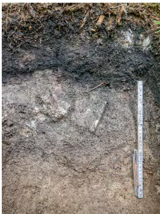
Abb. 74: Relikthangmoorgley mit rezenter Staunässe PPh-rGHg-SSg, RS-179, Legende 14
