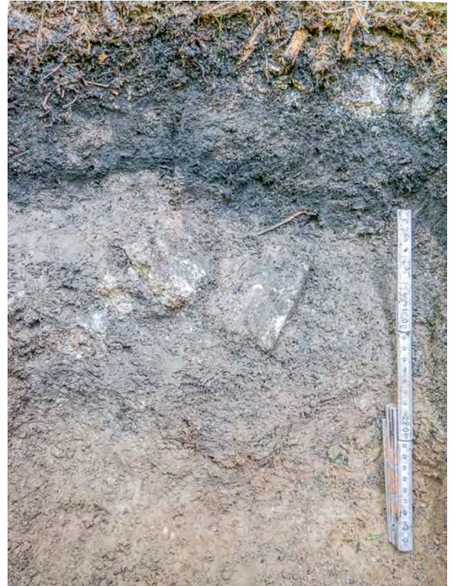
Abb. 149: Podsol-Relikthangmoorgley-Hangseudogley aus Granitverwitterung (RS-179)
