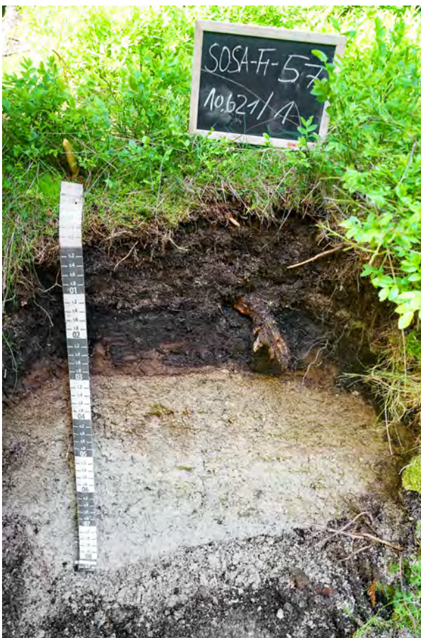
Abb. 98: Aufschluss FH-47: Moorgley (GGH) mit Schwemmschluff
