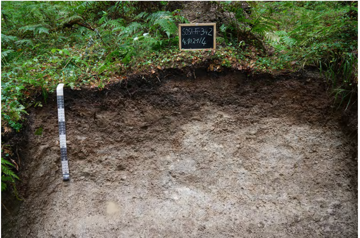
Abb. 243: Aufschluss FH-342 Braunerde-Pseudogley / Braunstaugley (FSK: EbGG 5 WM2); Umlagerung der Hauptlage durch u. a. Baumwurf bzw. anthropogene Tätigkeiten
