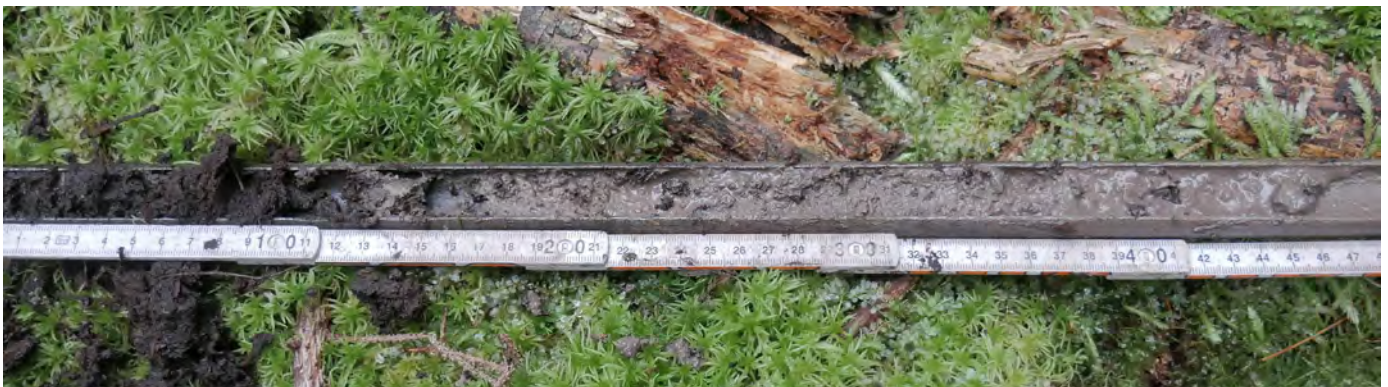
Abb. 80: Hangmoorgley mit Porensättigung ab ca. 2 dm Tiefe (RS-215) westliche Wallbach-Hangmulde
