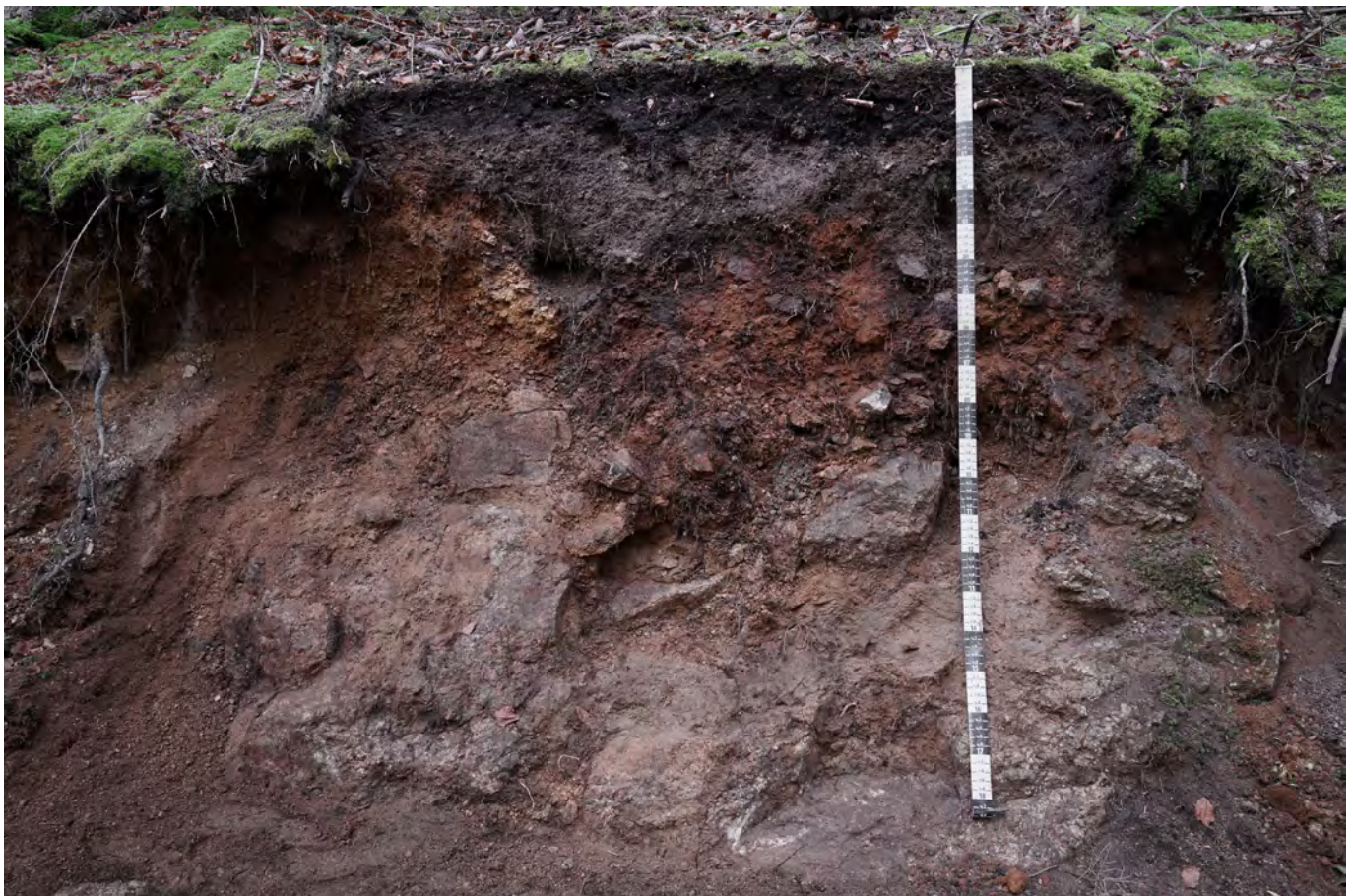
Abb. 223: Aufschluss FH-23 Riesenberger Granit Podsol (FSK: RiGt -5 TA2) aus Granitzersatz
