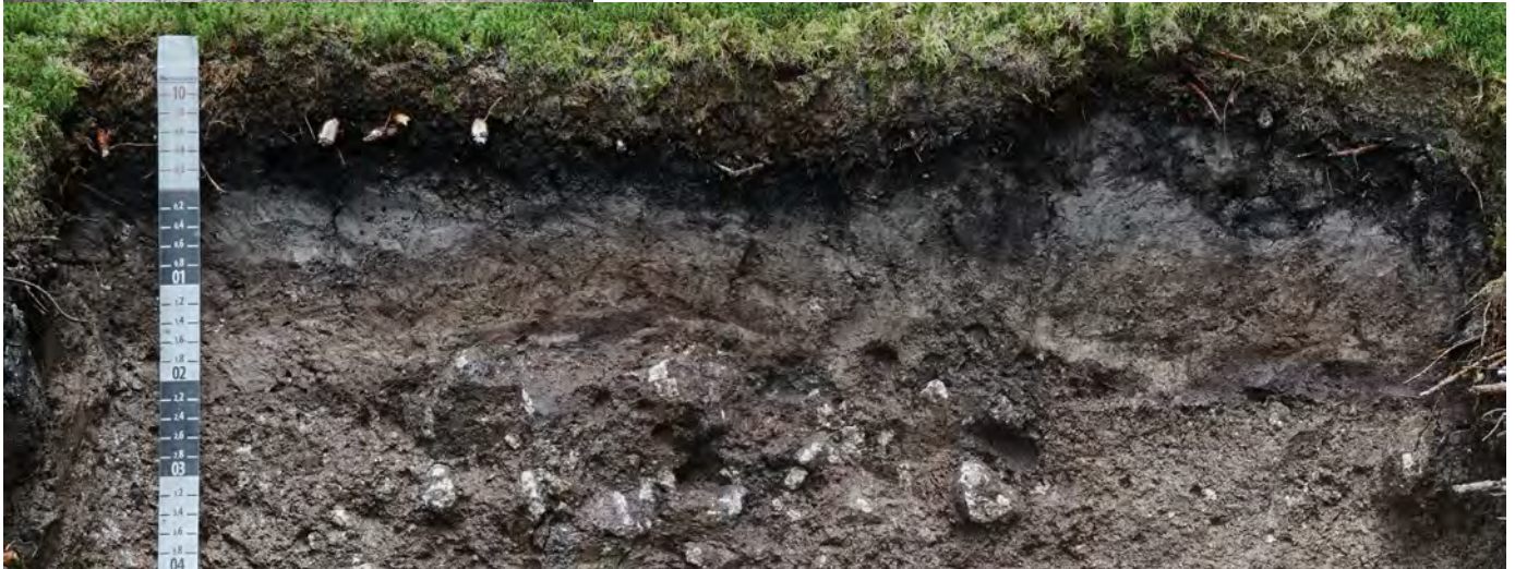
Abb. 98: Aufschluss FH-47: Moorgley (GGH) mit Schwemmschluff
