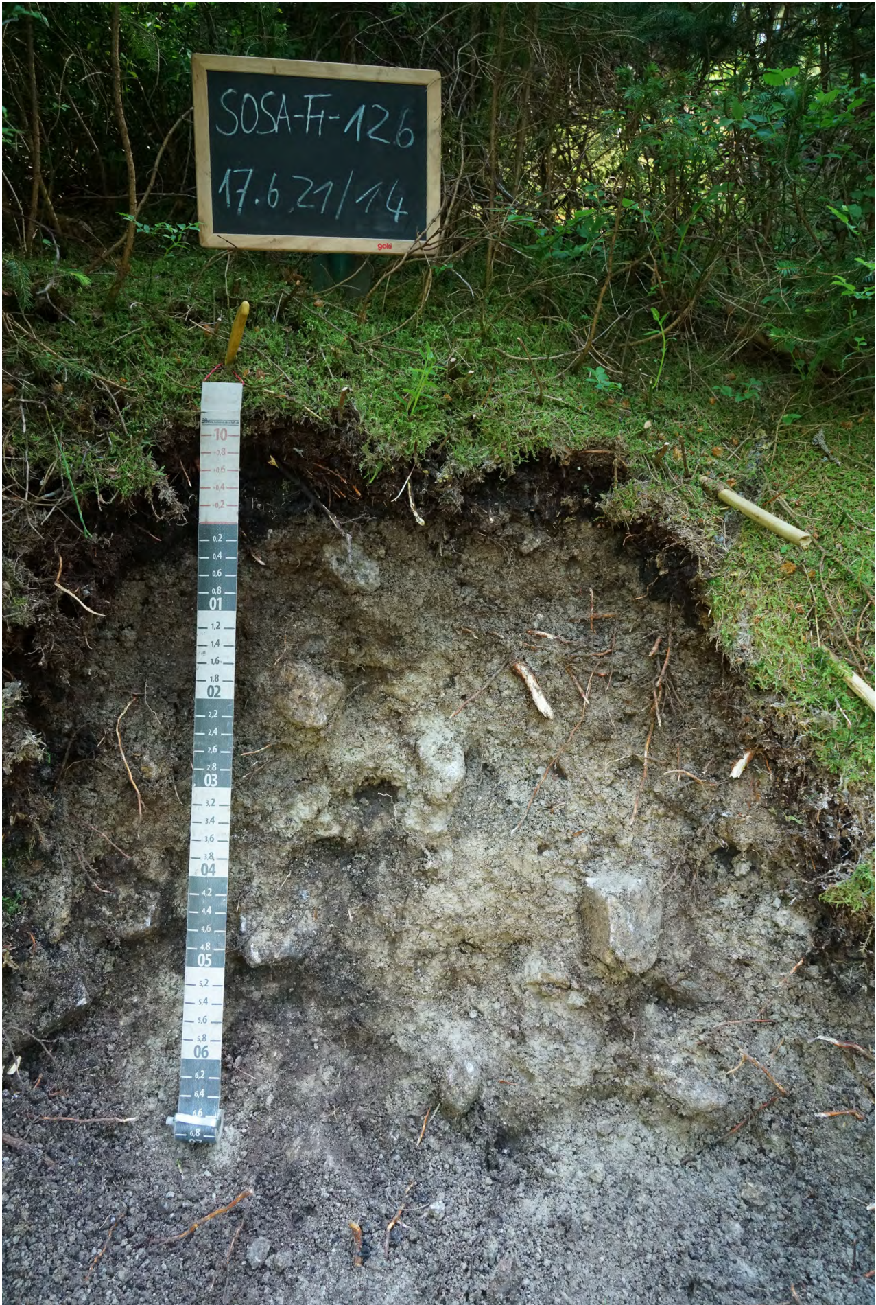
Abb. 233: Aufschluss FH-126 Pseudogley mit feuchtbedingter Humusanreicherung (FSK: EbGG...)
