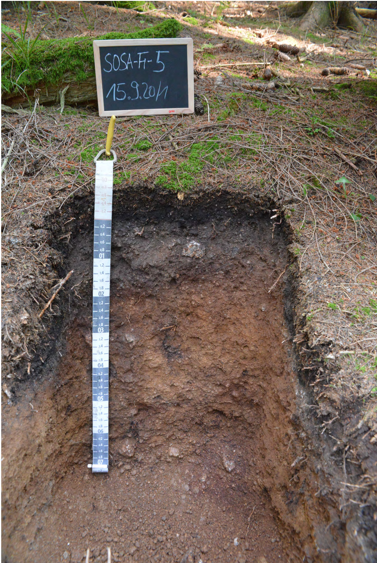
Abb. 218: Aufschluss FH-5 Eibenstocker Granit Braunpodsol (FSK: EbGt -5 TZ2) bzw. Braunerde-Podsol aus Granitzersatz
