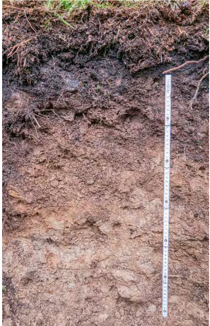
Abb. 143: Stark podsoliger Hangpseudogley aus schluffiger Phyllitverwitterung (RS-Hackstellen-Profil)
