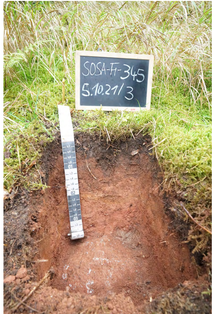
Abb. 103: rot gefärbte Schwemmschluffe Sie treten bevorzugt im Abstrombereich von Halden des Eisenerzabbaus auf.
