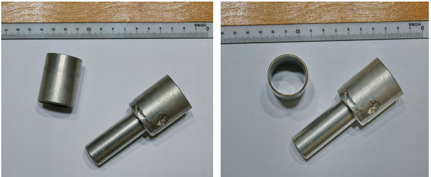
Abb. 24: Sonderanfertigung kleiner Stechzylinder
