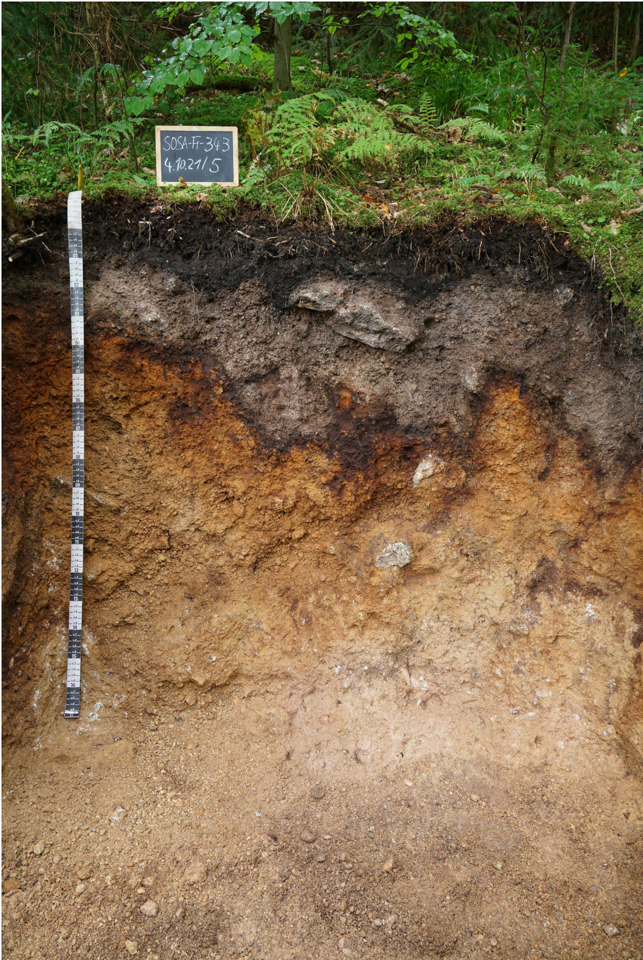
Abb. 244: Aufschluss FH-343 Normpodsol aus grusigem Granitzersatz (FSK: RiGt -5h TA2h)
