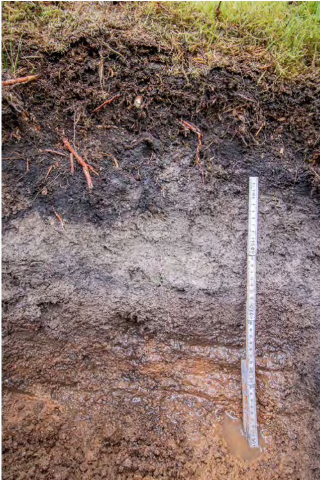
Abb. 135: Podsol-Hangpseudogley aus Granitverwitterung mit Porenwasseraustritt, November 2020 (RS-36)
