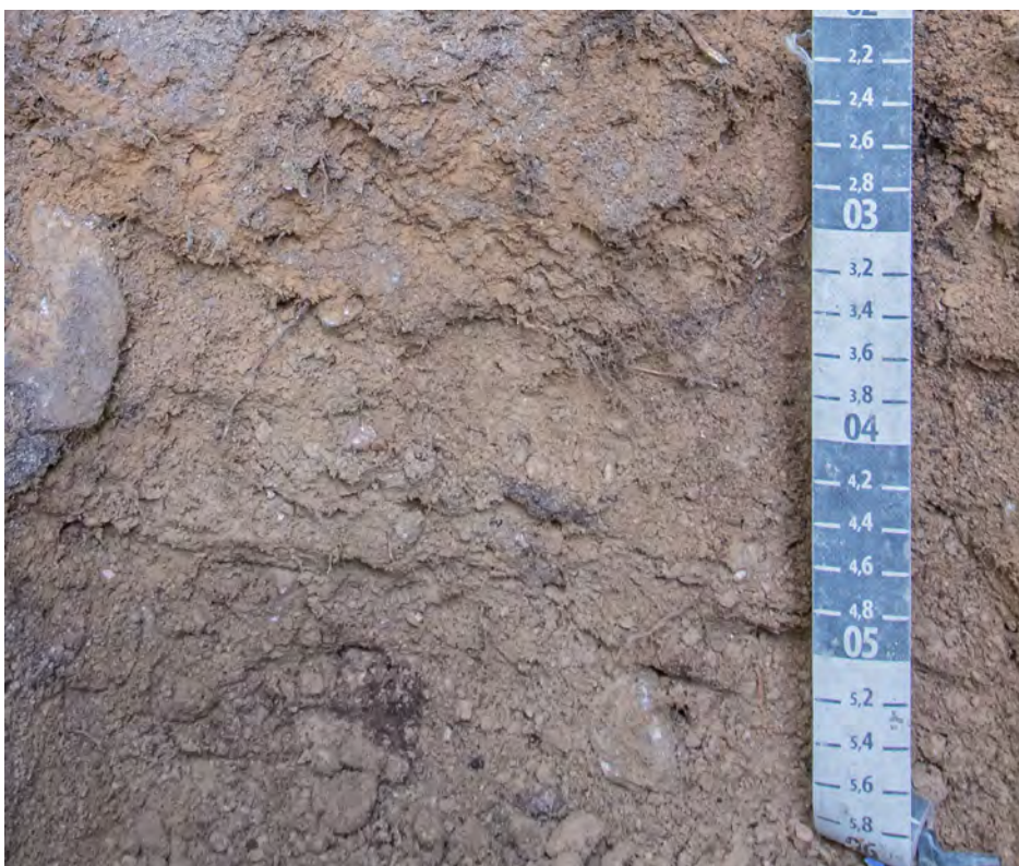
Abb. 131: Bsv-Horizont über C-Horizont aus grusig-sandig-lehmiger Granitverwitterung (RS-31)
