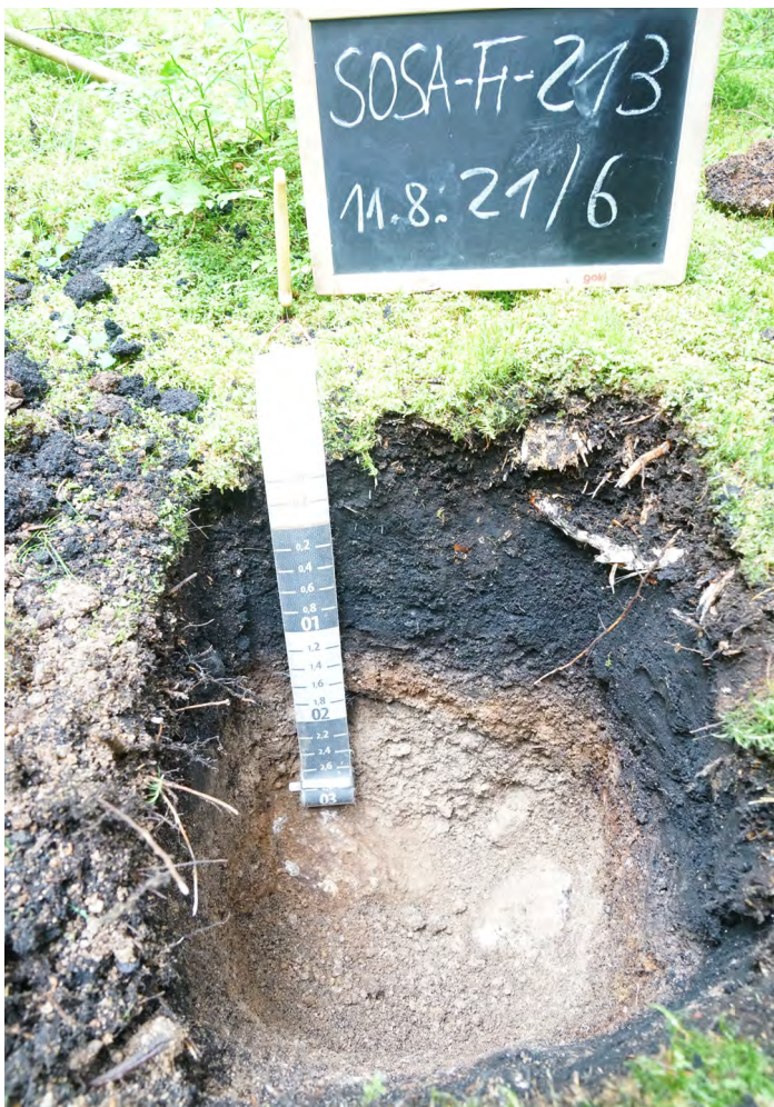
Abb. 101: rot gefärbte Verziegelung unterhalb einer Holzkohleschicht in Aufschluss FH-213
