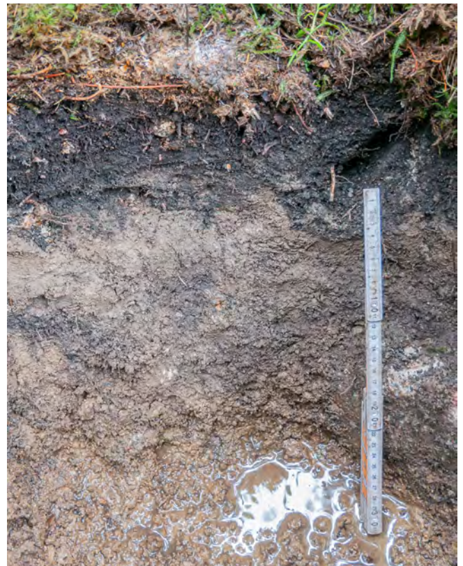
Abb. 157: Relikthangnassgley-Hangwechselgley mit diffusem Huminstoff-Eintrag (RS-177)
