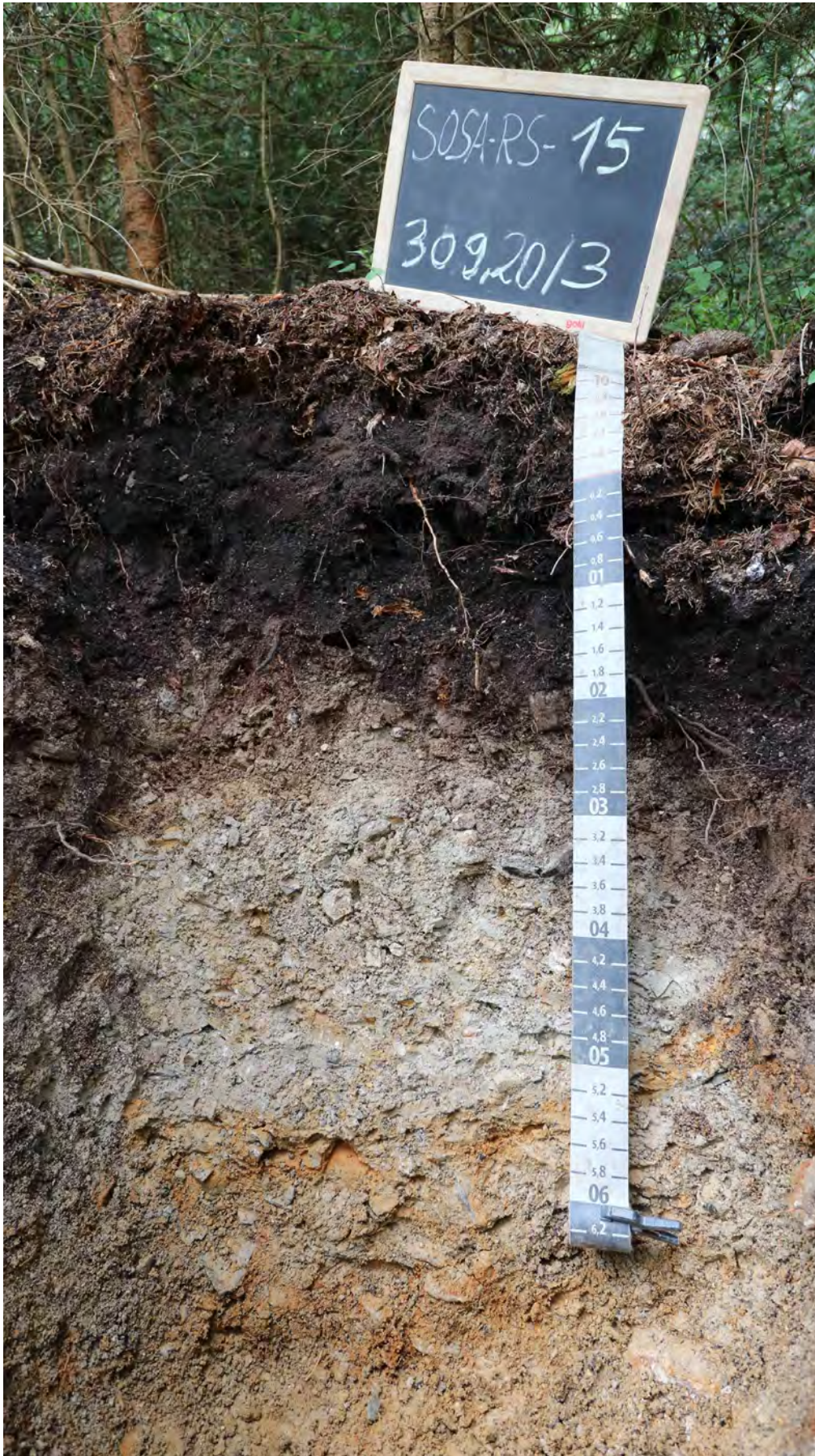
Abb. 251: Aufschluss RS-15 Satzunger Anmoorstaugley (FSK: SaGG ...) aus Zersatz kontaktmetamorpher Schiefer
