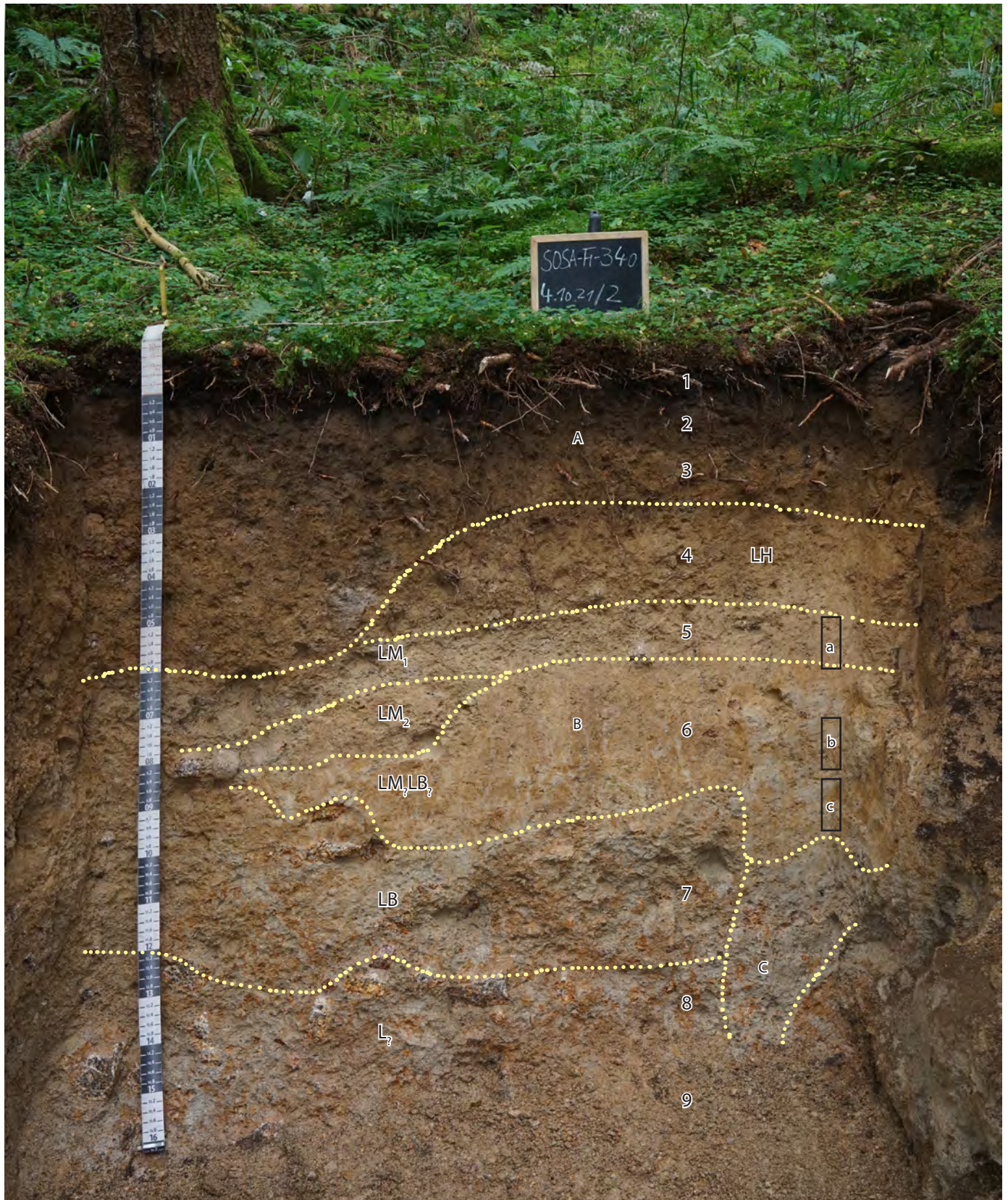
Abb. 108: Aufschluss FH-340: kolluviale Fahlerde-Hangpseudogley-Braunerde aus Schluff und sandig-grusiger Granitverwitterung
