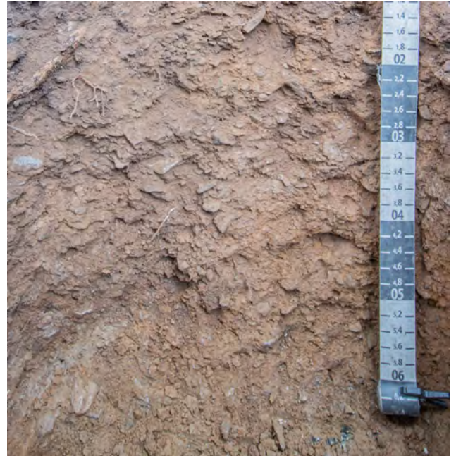
Abb. 130: Bv mit Übergang zu C-Horizont, lehmig-sandige Phyllitverwitterung (RS-4)
