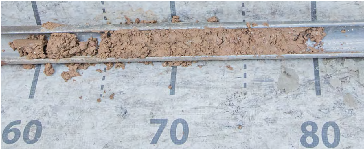
Abb. 140: Gering hydromorph zeichnender sSwd (RS-1), trocken, September 2020
