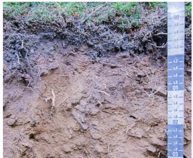
Abb. 123: Typischer Moder und Ae + Ae über Bsv aus lehmig-sandiger Granitverwitterung (RS-24)
