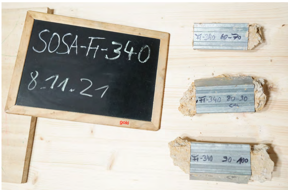
Abb. 25: Proben für die Dünnschliffanalyse
