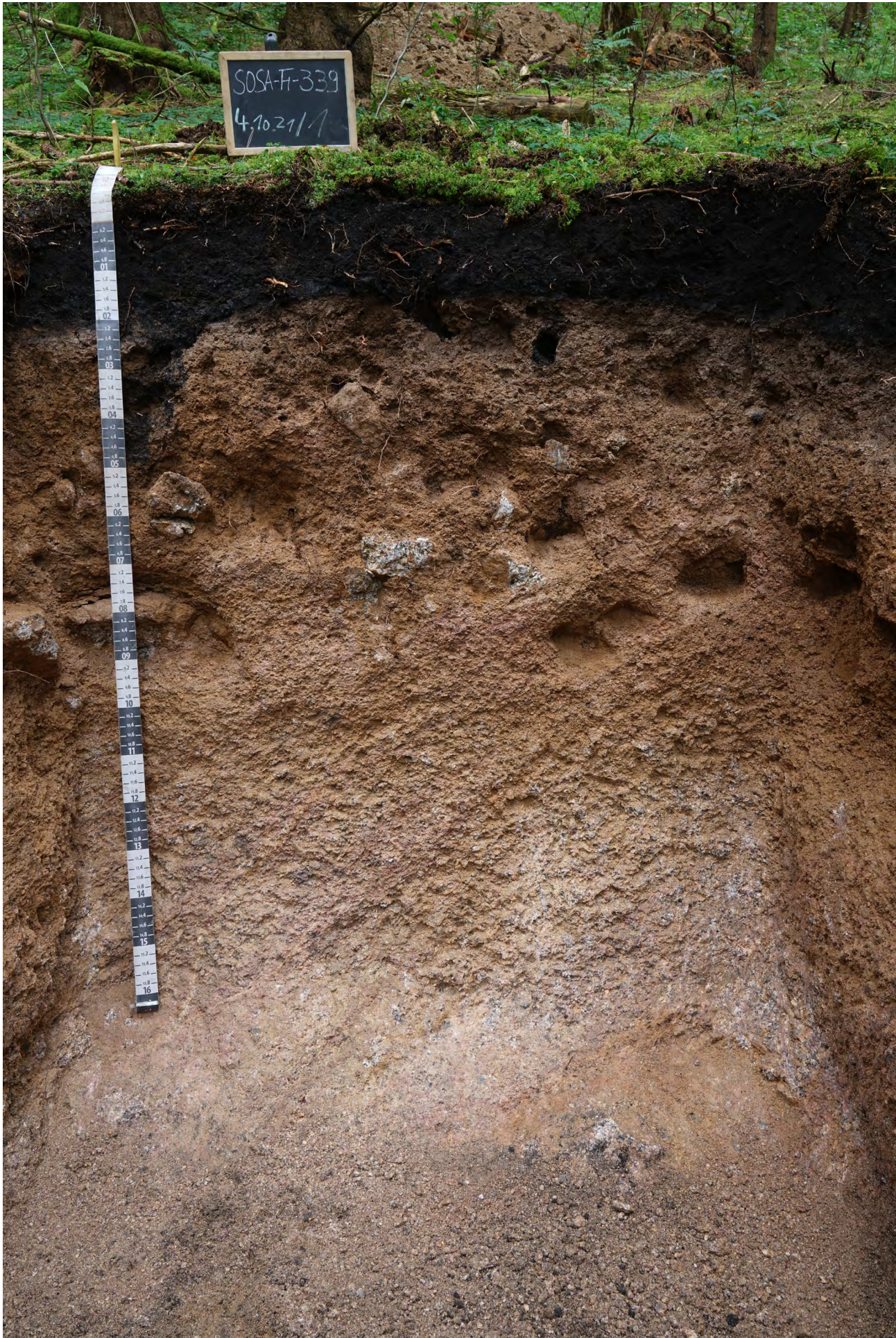
Abb. 241: Aufschluss FH-339 historische Köhlerplatte, die eine Braunerde (FSK: SsGt -5 TM2) überformt
