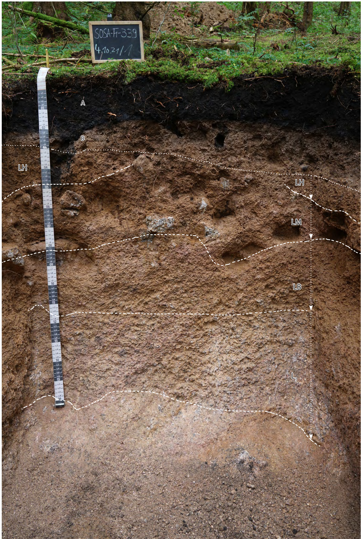
Abb. 118: Lagenzonierung im Solum des Aufschlusses FH-339 LH: Hauptlage, LM: Mittellage, LB: Basislage, L: unbezeichnete Lage A: Holzkohleschicht, B: Schicht anthropogener Umlagerung
