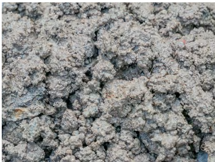
Abb. 153: Feuchtmoder über rsGr°SGhw, rGNg-GGg (RS-182)
