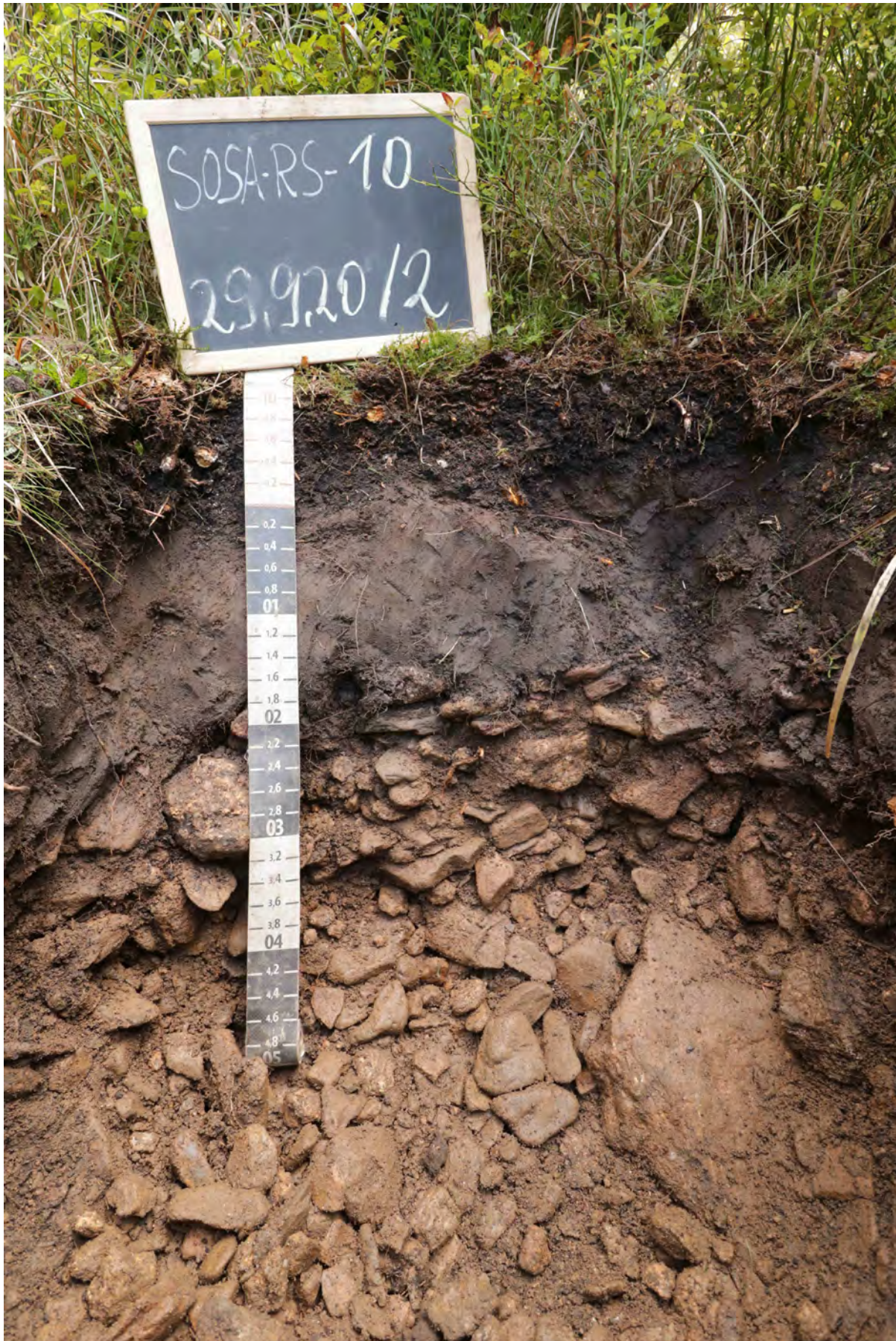
Abb. 248: Aufschluss RS-10 durch Zinnseifenabbau überprägte Bachaue (FSK: Yzlz ...)
