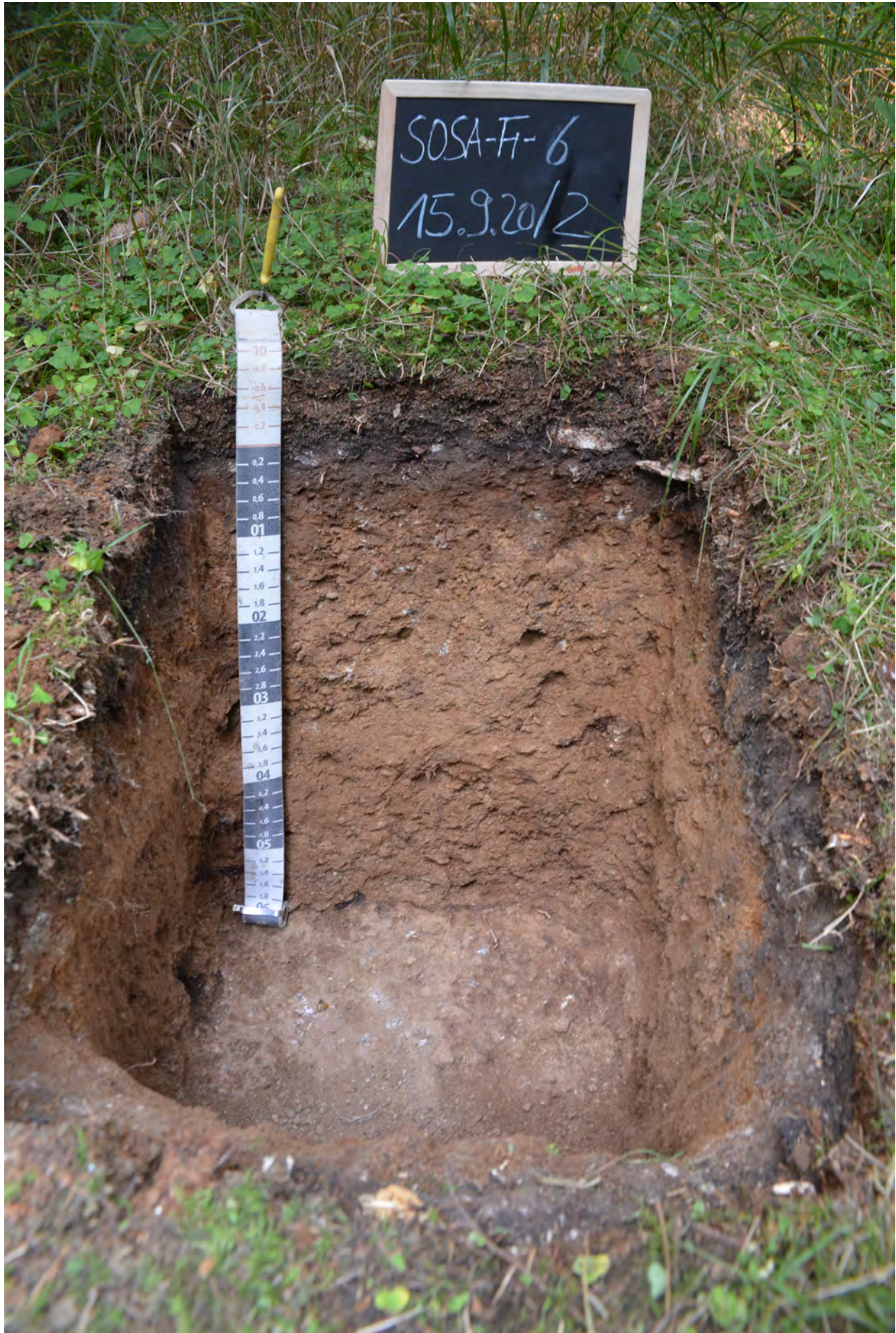
Abb. 219: Aufschluss FH-6 Sosaer Granit Braunerde (FSK: SsGt -5 TM2) aus Granitzersatz mit hohem schluffigem Anteil
