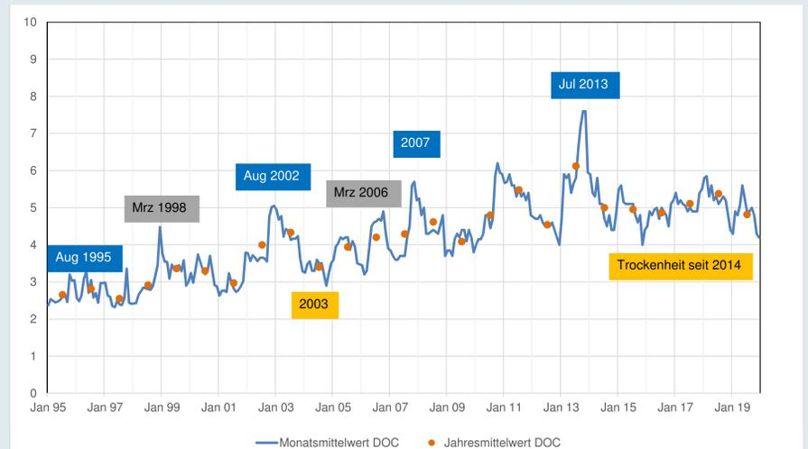
**Abbildung:** DOC-Konzentration (mg/l) im Rohwasser der Talsperre Eibenstock 1995 – 2019. Auswirkung von **Starkregenereignissen** und **Schneeschnmelzen** sowie **Trockenjahren** auf den DOC-Gehalt im Rohwasser der Talsperre
