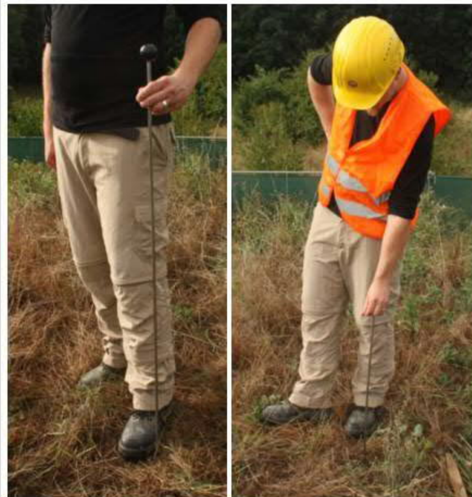
Abbildung 6: Handsonde zur einfachen taktischen Erfassungen des Eindringwiderstandes
