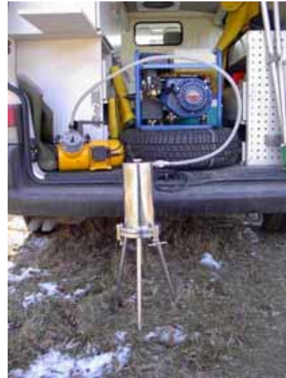
Abbildung 18: Apparatur für die Vor-Ort-Filtration
