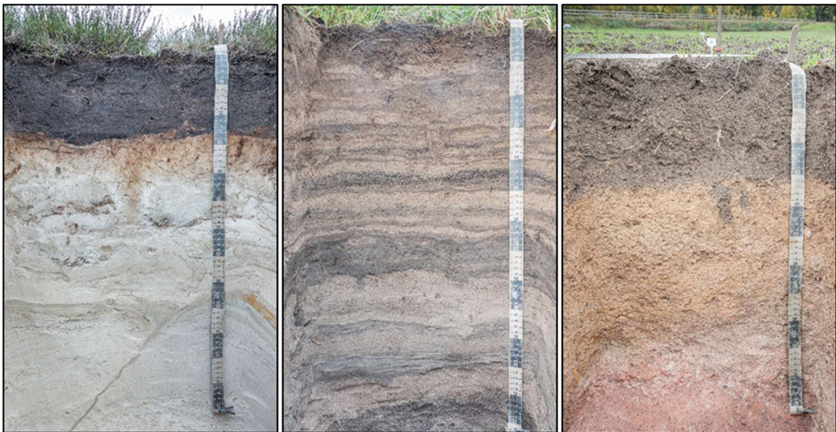
Abbildung 2: Profilaufnahmen eines Reliktgley-Podsols (links), einer Normvega (Mitte) und einer Pseudogleybraunerde (rechts) (© Ralf Sinapius)
