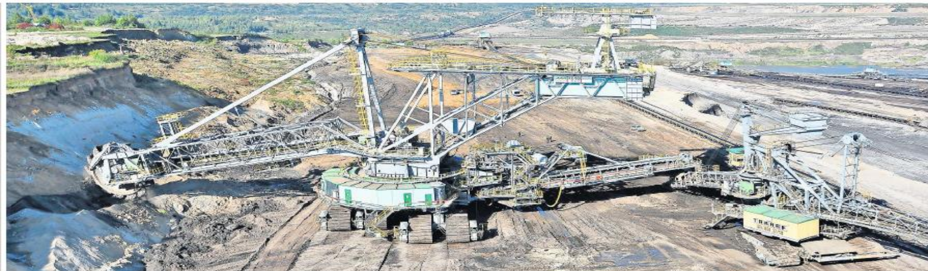
Noch wird im Mitteldeutschen Revier Braunkohle gefördert – wie hier von einem Schaufelradbagger im Tagebau Vereinigtes Schleenhain. Das neue Bündnis plant schon für die Zeit danach.
