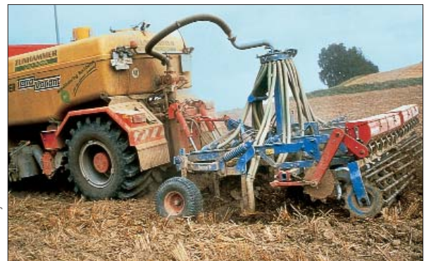
Abb. 42: Gülleausbringung, Gülleeinarbeitung und Zwischenfruchtsaat in einem Arbeitsgang
