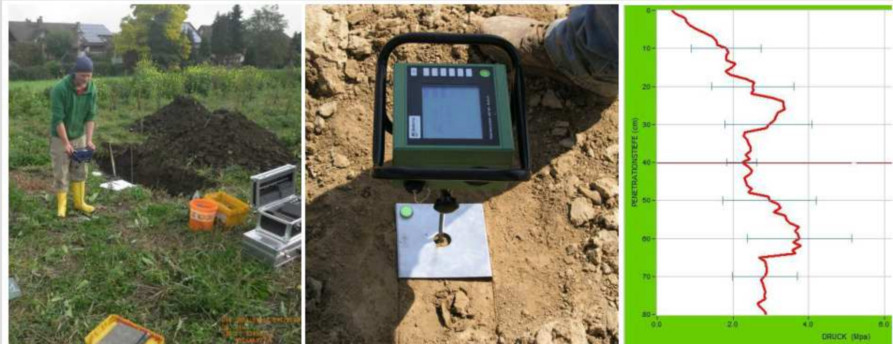
Abbildung 7: Handpenetrologger bei der Rekultivierungskontrolle; Grafik des Eindringwiderstandes als Mittelwert von 10 Wiederholungen (rechts)
