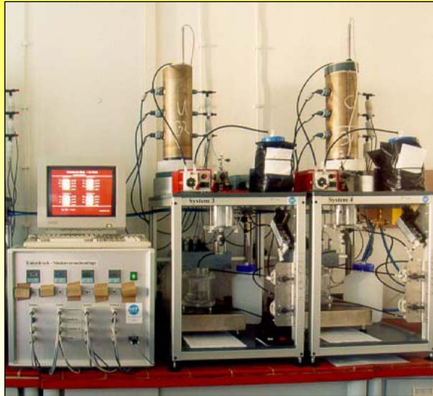
Abb.: Unterdruck-Säulenanlage für ungesättigten Säulenversuch
