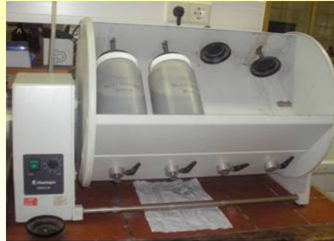
Überkopf-Schüttler für Versuch nach DIN 19529 -
