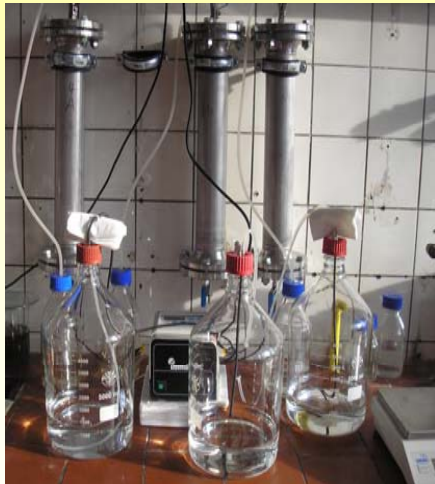
Säulenversuchs-Aufbau nach DIN 19528
