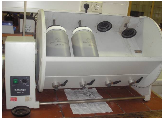
Abb. 2: Klassischer Überkopfschüttler für Versuche nach DIN 38414-4 und DIN 19528 / E DIN 19527.
